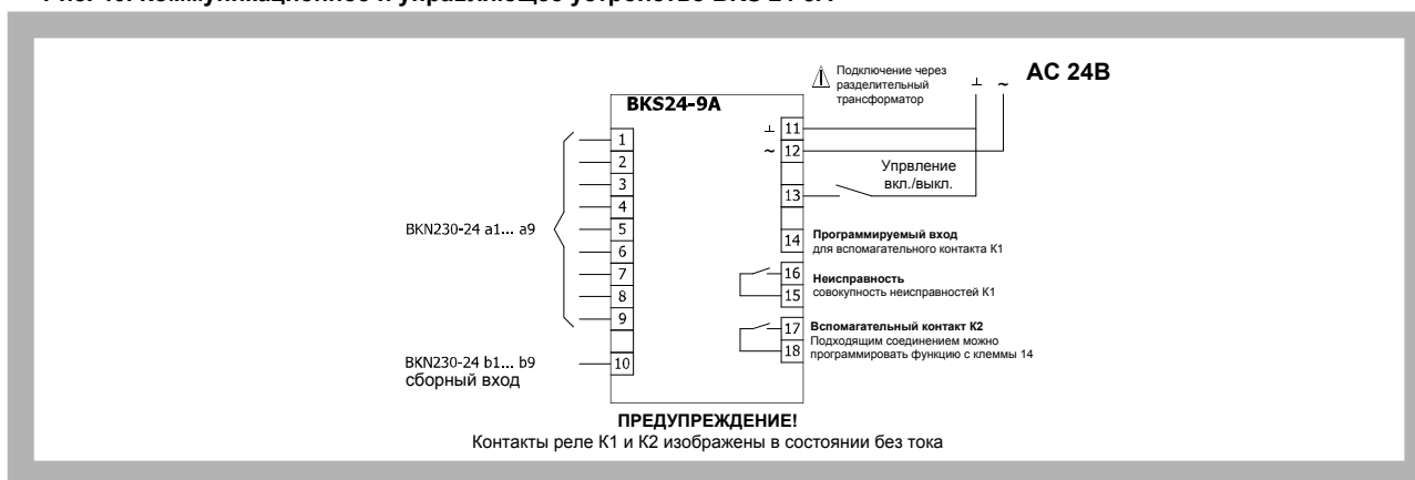
Рис. 40. Коммуникационное и управляющее устройство ВКС 24-9А
